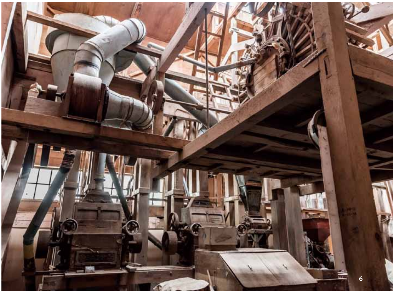
現在は使用していないが、かつて使われていた製粉機。ひとつのモーターで歯車などが動き出し、全体が稼働する仕掛け。
